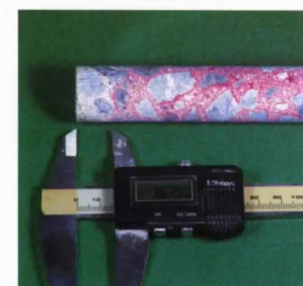
中性化深さの測定状況
